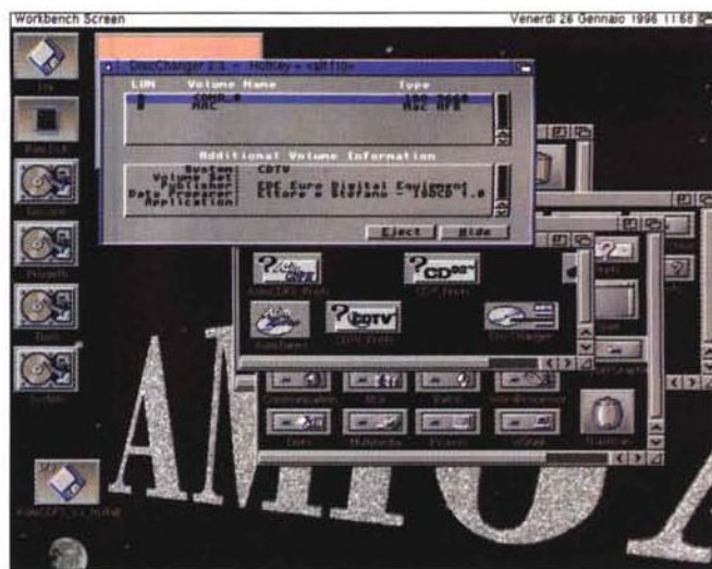
Con la Commodity DiskChanger si possono selezionare quali formati leggere nel caso di CD-ROM multiformato. In alcuni casi è anche possibile mostrare informazioni aggiuntive relative al creatore del CD-ROM.
